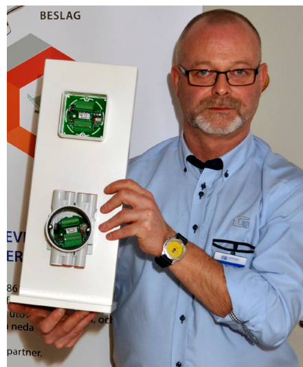
Stefan Adolfsson, på Göthes Industribeslag, visar upp Avlämningspunkt GIB01 – en produkt som kommer att betyda mycket för installationen av elektroniska låssystem och sensorer i dörrpartier.
